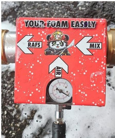
Il sistema RAFS nasce dall'esigenza di disporre di un generatore di schiuma CAFS compatto, leggero e affidabile, privo di motori, elettronica e componenti complessi. La sua progettazione punta alla semplicità: meno apparati, meno manutenzione, massima efficienza.
