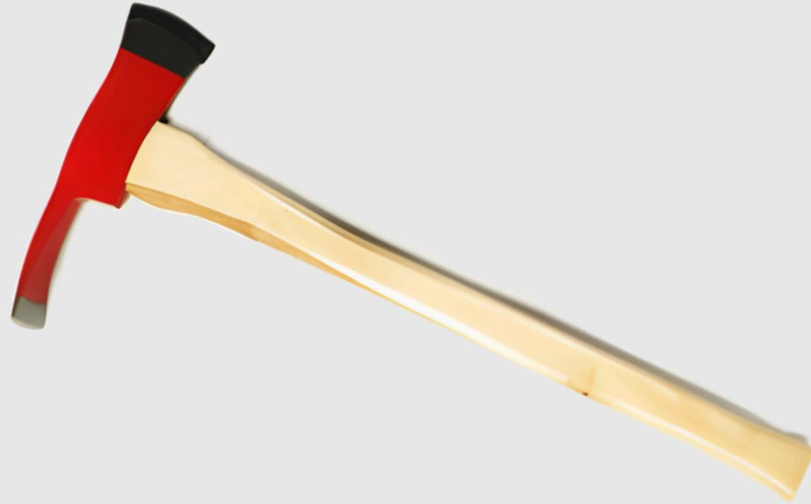
Testa realizzata in acciaio fucinato. Le estremità sono state sottoposte a trattamento termico per ottenere una grana da 45 a 55 HRC e conferire maggiore sicurezza, resistenza e durezza. Testa smaltata di rosso e fili di taglio trattati con lacca trasparente per ridurre la formazione di ossido.
