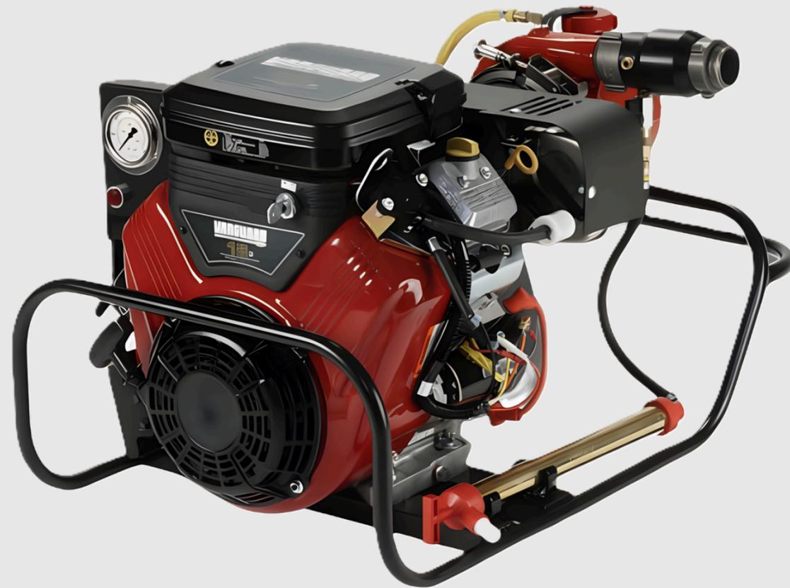
Motopompa portatile ad alta pressione con motore Briggs & Stratton Vanguard "V Twin" da 18 CV, 4 tempi, raffreddato ad aria, dotato di protezione contro il fuorigiri e avviamento elettrico (con backup manuale). La pompa a 4 stadi, compatibile con schiumogeni, è intercambiabile con altri modelli (4 stadi e 2 stadi F200) per maggiore flessibilità. L'accoppiamento motore-pompa avviene tramite morsetto rapido in acciaio inox con moltiplicatore esente da manutenzione.
