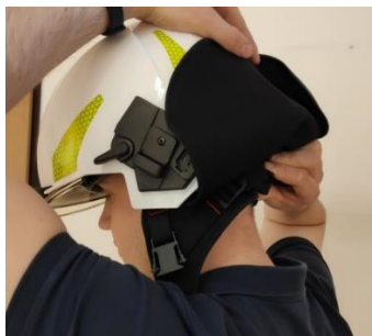
Fig.15 Cintura a fascia con cintura di sospensione all'interno del casco
