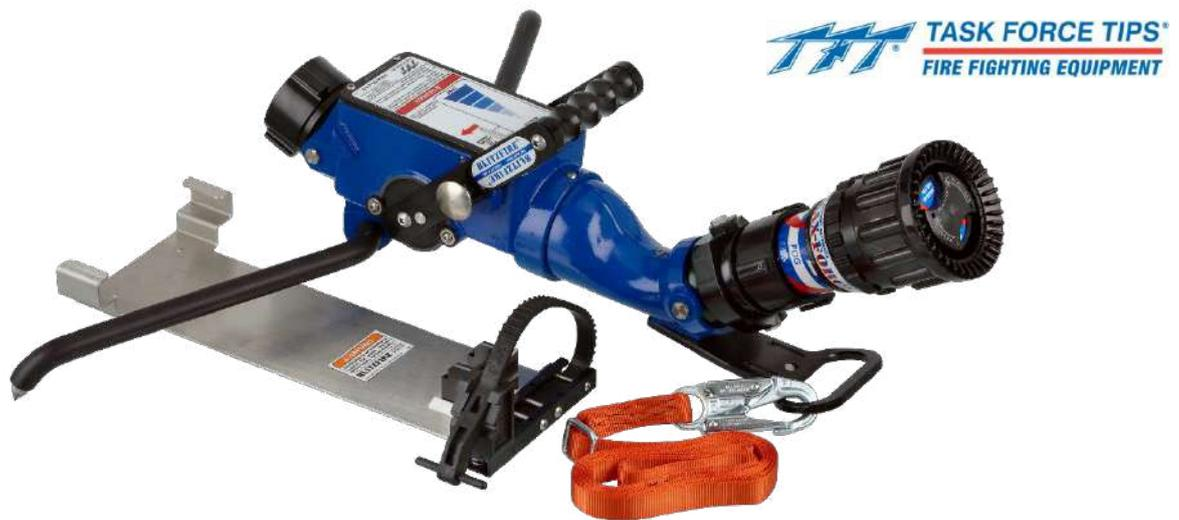
Il monitor Blitz Fire ha una portata di erogazione **da 400 lt. sino a 2000 litri al minuto** con una gittata massima di **61 metri**. Il monitor è stato progettato in modo da ridurre al massimo tutti gli attriti di ingresso e di uscita eliminando per tanto la totalità delle perdite di carico.
