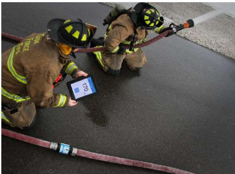
SHO-FLOW® Bluetooth® è un misuratore di portata d'acqua progettato per l'installazione tra due manichette con raccordi da 1.5" (38 mm) o 2.5" (65 mm). Sono disponibili tre modelli a seconda della portata desiderata. Qualsiasi operazione di antincendio, addestramento o di collaudo che utilizza lance o manichette è un'applicazione per il flussimetro SHO-FLOW Bluetooth.
