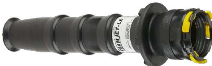
**TFT cod. FJ-LX-G** : Adattatore per la produzione di schiuma a bassa espansione, per tutti gli ugelli serie G-Force da 1,5" media pressione PN16. Fornisce un'eccellente schiuma a bassa espansione con una struttura a bolle strette. È realizzato in polietilene stabilizzato UV resistente, acciaio inossidabile e alluminio.
