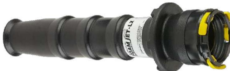
**TFT cod. FJ-LX-U-G** : Adattatore per la produzione di schiuma a bassa espansione, per tutti gli ugelli serie G-Force A.P. PN40 con attacco da 1" (25 mm); fornisce un'eccellente schiuma a bassa espansione con una struttura a bolle strette. È realizzato in polietilene stabilizzato UV resistente, acciaio inossidabile e alluminio.
