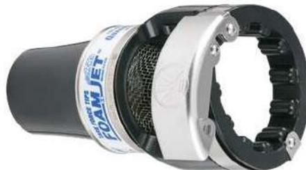
**TFT cod. FJ-GD** : Adattatore per la produzione di schiuma a bassa espansione, per tutti gli ugelli serie G-Force A.P. PN40 con attacco da 1" (25 mm); realizzato in gomma stampata, acciaio inossidabile e alluminio nichelato leggero.
