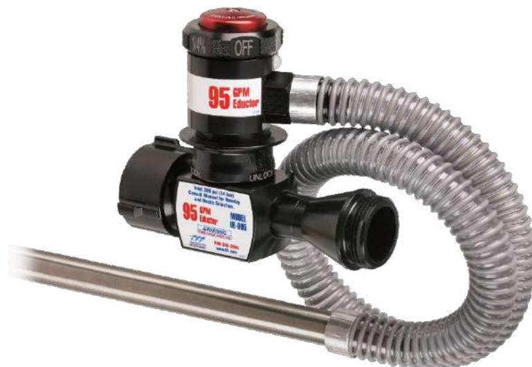
Dotato di attacchi da 1.5" F x 1.5" M , completo di tubo aspirante e selettore di miscelazione rotante, con posizioni di: chiusura (OFF) e miscelazione al **0,25% - 0,5% - 1% - 3% - 6%**. Realizzato in una lega di alluminio anticorrosione, è estremamente piccolo e leggero. Peso (senza raccordi): Kg. 2,00 – progettato per un facile utilizzo con i guanti.
