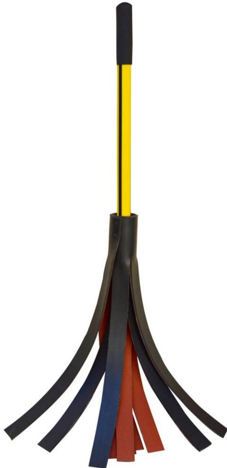
Strumento di soffocamento che agisce in modo simile al **flabello antincendio**, estinguendo e soffocando la fiamma eliminando l'ossigeno quando colpisce la linea di tiro. L'uso è consigliato per terreni con rilievi e irregolarità, suoli rocciosi, o vegetazione chiusa dove è scomodo lavorare con il flabello classico.
