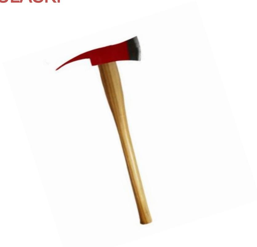
Testa realizzata in acciaio fucinato. Le estremità sono state sottoposte a trattamento termico per ottenere una grana da 45 a 55 HR per conferire maggiore sicurezza, resistenza e durezza. Testa smaltata di rosso e fili di taglio trattati con lacca trasparente per ridurre la formazione di ossido.
