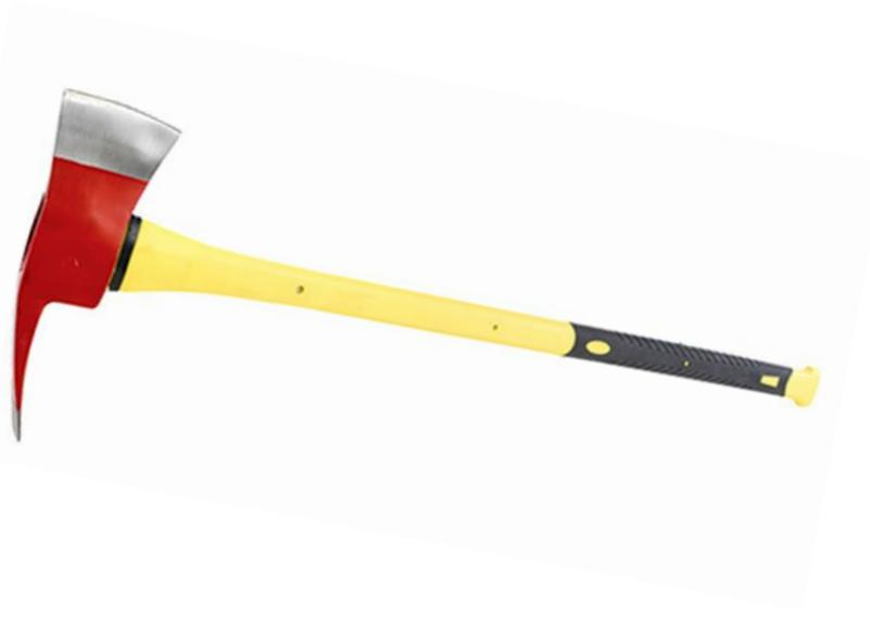
Il **Pulaski** è uno degli attrezzi manuali più diffusi e utilizzati nella lotta agli incendi boschivi. Lo strumento combina un'ascia e una zappa in un'unica testa. Il Pulaski è uno strumento versatile per la costruzione tagliafuoco, poiché può essere utilizzato sia per scavare e raschiare il terreno minerale, sia per tagliare e aprire linee nella vegetazione.
