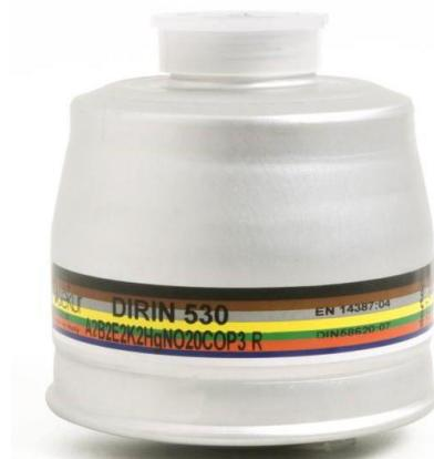
**DIRIN 530 A2B2E2K2HgNO 20COP3 R** è un filtro combinato polivalente con involucro in alluminio e vite unificata secondo la **EN 148-1**. Da utilizzare con le maschere a pieno facciale, purchè con attacco a vite EN 148-1.
