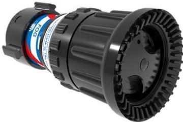
Ugello con portate da 400-2000 l / min. L'ugello può essere regolato con una pressione di esercizio standard 7 bar, o in modalità bassa pressione a 4 bar, ruotando una manopola posizionata sulla parte anteriore dell'ugello.
