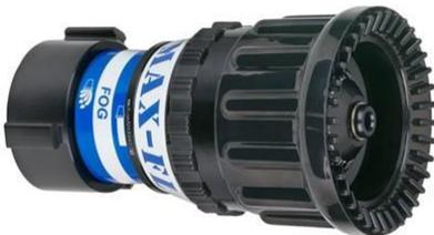
Ugello con portata fissa 2000 l/min, ideale per l'utilizzo in presenza variazioni di pressione estreme. L'ugello funzionerà con pressioni fino 2 bar.
