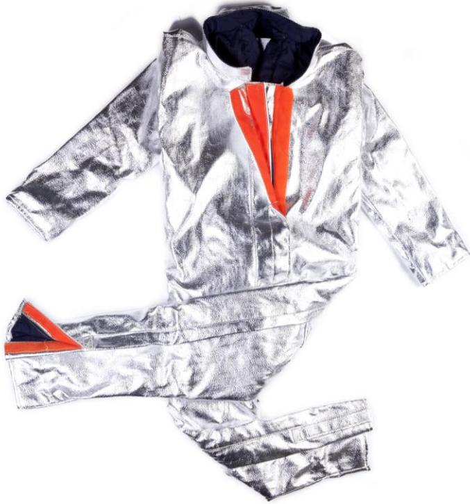
Tuta intera di avvicinamento al fuoco realizzata in tessuto alluminizzato SAFAL GREEN da 340 gr. (50% para-aramidico 50% Panox®), internamente coibentati con tessuto OXISTOP da 325 gr. composto da: feltro in fibra preossidata da 200 gr. trapuntato con fodera in tessuto 50% aramidico 50% viscosa FR da 125 gr.
