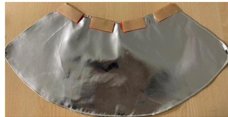
Paranuca realizzato con tessuto alluminizzato SAFAL GREEN da 340 gr. composto da 50% para-aramidico 50% Panox®. Utilizzabile su ogni tipo di elmetto.
