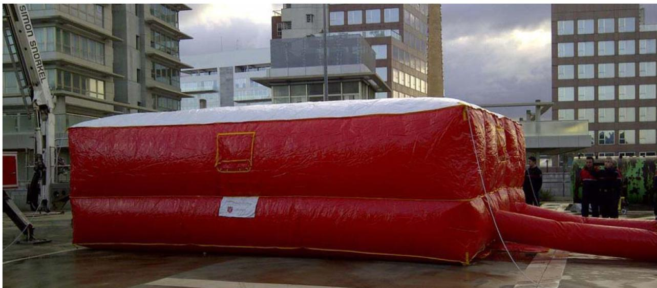
I cuscini da salto modello SAF.R.C. sono cuscini composti da **due camere gonfiabili**: la prima, detta camera superiore grande, funge da area di primo impatto; la seconda, detta camera inferiore piccola, funge da area di secondo impatto.
